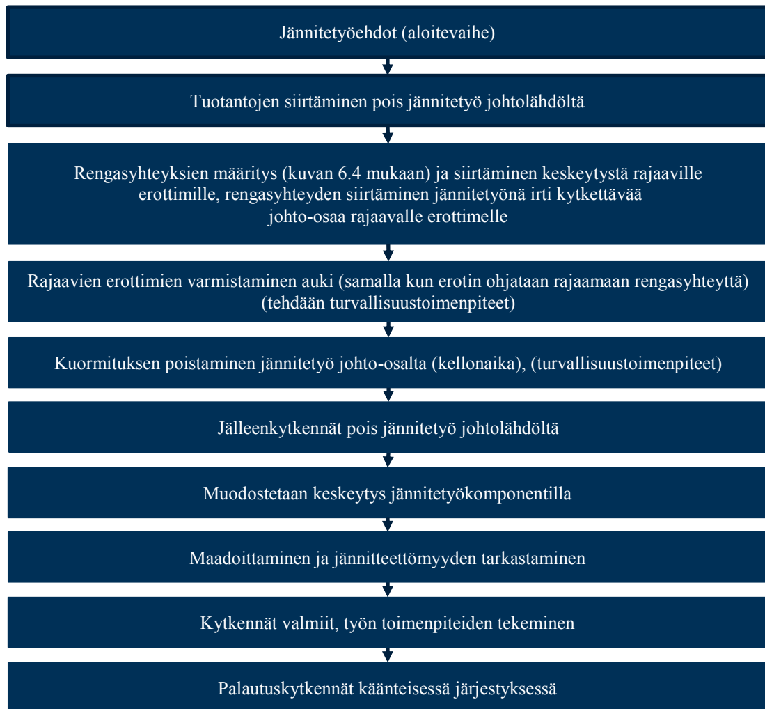
Kuva 6.6 Kytkentäohjelman muodostaminen jännitetyöhön, jossa otetaan verkkoa jännitteettömäksi.
