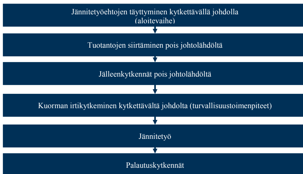
Kuva 6.5 Automaatiojärjestelmän toiminnot jännitetyön yhteydessä.
