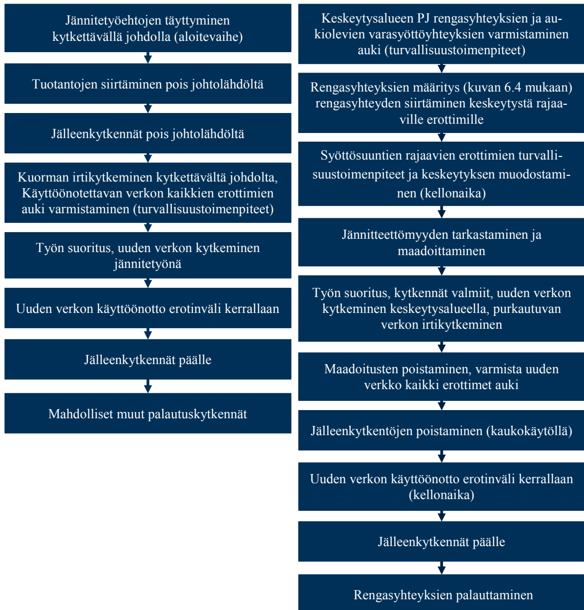
Kuva 6.7 KytKentäohjelma uuden verkon käyttöönotossa. Vasemmalla jännitetyö, jossa on dokumentointi. Oikealla keskeytystyö, jossa on dokumentointi.
