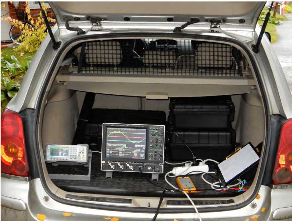
Kuva 7.34. HFCT-mittauslaitteisto henkilöauton tavaratilassa (oskilloskooppi, differentiaalimittapää 50 Hz vaihejännitteen mittaamista varten (pj-rasiasta) ja signaaligeneraattori kaapelin pulssituksesta varten).
