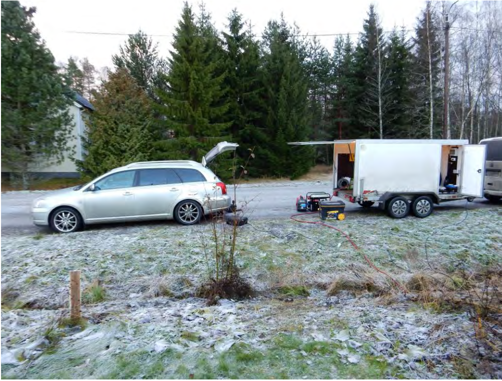
Kuva 7.33. Peräkärriyn asennettu off-line-osittaispurkausmittauslaitteisto (kuvassa oikealla).
