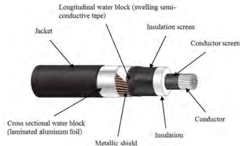
Kuva 2.7. Muovikaapelin rakenne [Rek10a].
