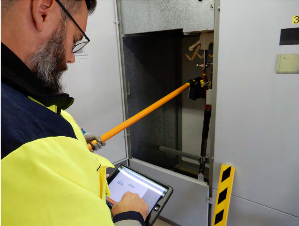
Kuva 7.35. Pry-Cam-mittauslaitteisto (kennossa eristyssauvan päässä Pry-Cam portable ja kädessä mittausohjelmistolla varustettu iPad).
