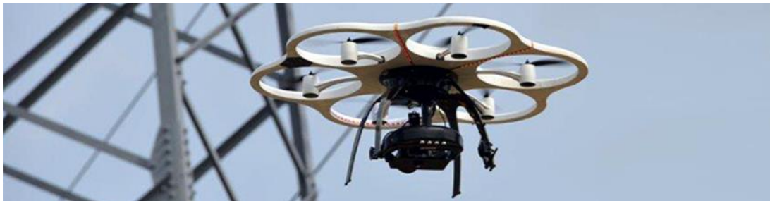
Kuva 1 - Itävaltalainen sähkökäyttöinen Aibotix-robottihelikopteri verkoston tarkastustehtävissä
