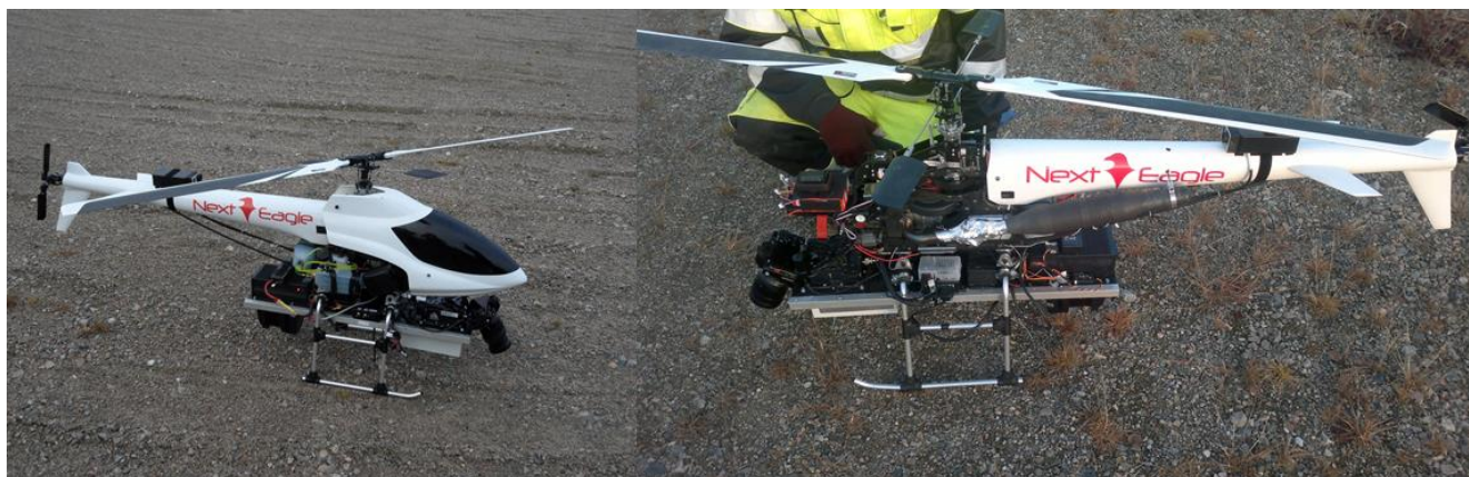
Kuva 2. Robottihelikopteri JR GSR260Z tarkastuslentovarustuksessa
