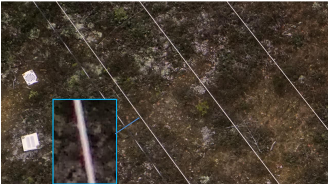
Kuva 14. Lentorobotin kuvassa 20 kV:n johto, pj-ilmakaapeli ja signaalimerkkejä
