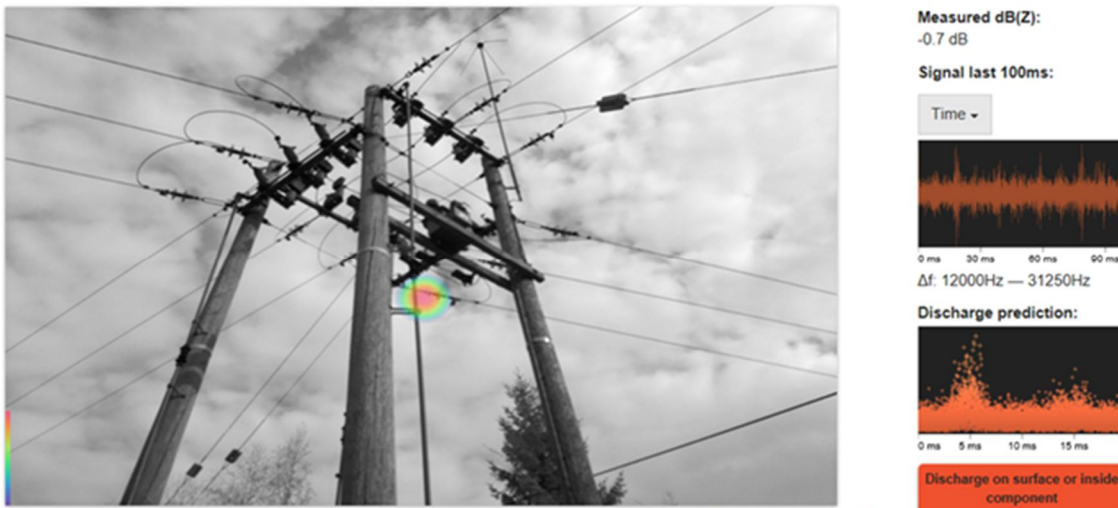
Kuva 4.11. Vaimea purkaus Kyynärmäen erotinasemalla (7.5.2019, 9 °C, 35 %).
