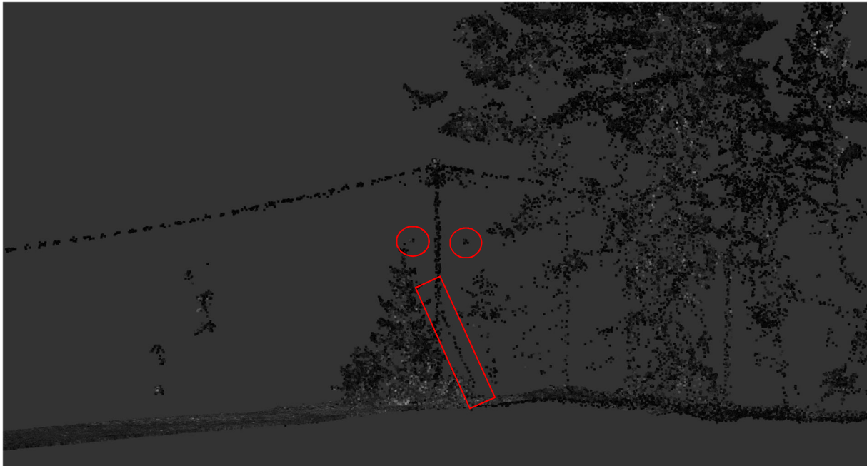
Kuva 5.8. Pistepilvestä tehty leikkauskuva, johon merkitty punaisilla ympyröillä haruseristimet ja punaisella suorakaiteella pylvästukirauta.
