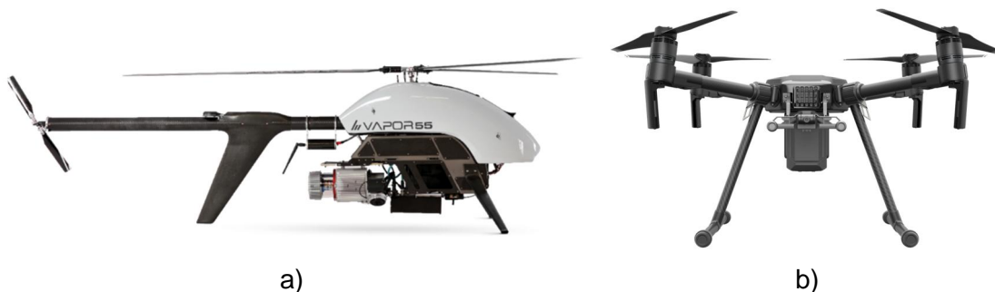
Kuva 5.3. Kaksi erilaista dronekopteria, a) yksiroottorinen helikopteria muistuttava ja b) moniroottorinen dronekopteri. Kuvat: www.skylineuav.com.au , www.dji.com .
