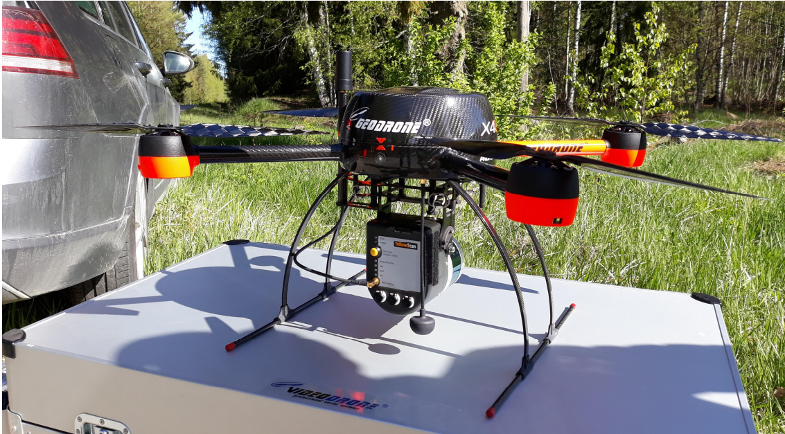
Kuva 5.6. Laserkeilaukseen käytetty GeoDrone ja YellowScan-laserkeilain-GNSS-IMU-yhdistelmä.
