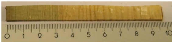
Kuva 1 Tampereen Teknillisen Yliopiston tutkimuksessa havaittiin, että CCA-pitoisuudet pienenevät merkittävästi, mitä syvemmltä tarkastellaan.
