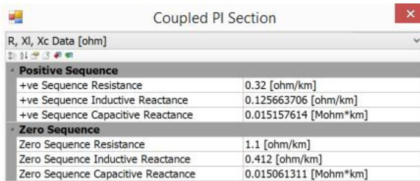
Figure 8. AHXAMK-W 3x95 cable parameters
