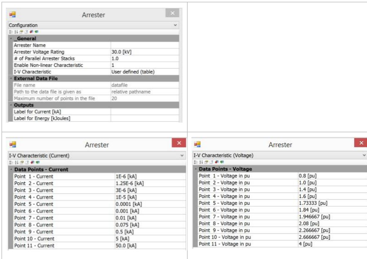
Figure 14. Surge arrester parameters
