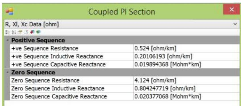
Figure 9. HXCMK 3x1x35 cable parameters
