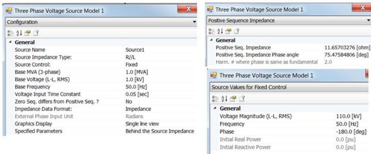
Figure 12. Voltage source parameters
