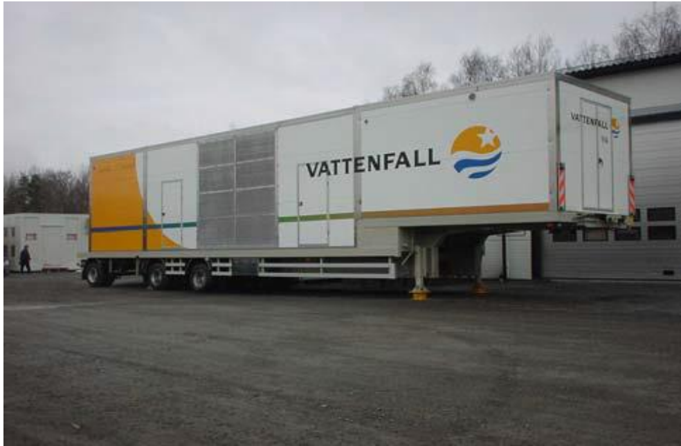
Kuva 4.7. 52/24(12) kV siirrettävä sähköasema (Lord, 2007).
