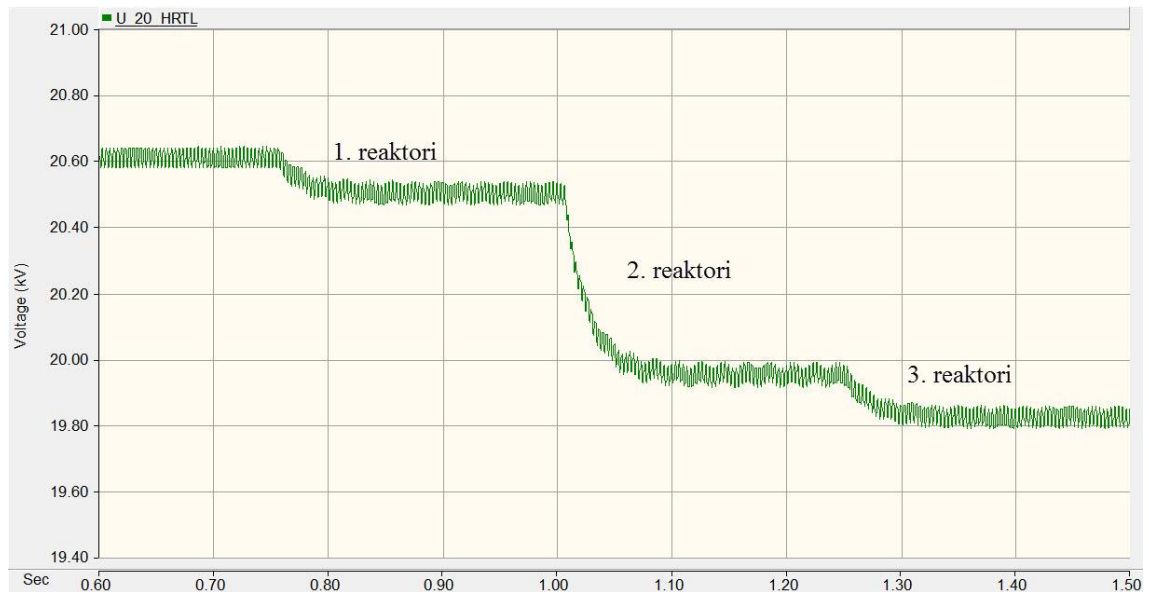
Kuva 19. Hartolan sähköaseman toisiopuolen jännitemuutokset reaktoreiden kytkennöistä
